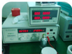
直流稳压测试 调整输出电压达到稳压输出的目的
